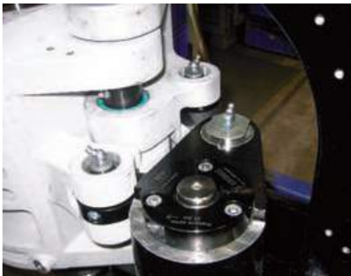
Hävvarm låst med ETP-EXPRESS för öppning/stängning av kaviteten.
